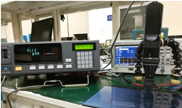
图 15 使用 CA-310 量测莫尔条纹中心区域的闪烁度的值
