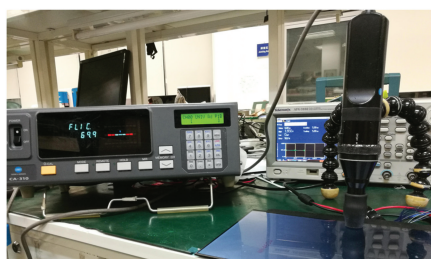
图14 使用色彩分析仪CA-310量测莫尔条纹中心区域的闪烁度
